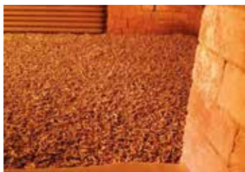
A) Spalanie pelletu z biomasy agro z dodatkiem mineralnym w piecu retortowym – popiół jest sypki, brak spieków
